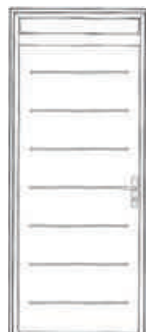
ÉQUATION HAUTEUR MAXIMUM AVEC IMPOSTE H 2350 L 900 Au-delà de 2250 mm, possibilité de mettre une imposte de 200 à 450 mm pour une hauteur maximum porte + imposte de 2350 mm.
