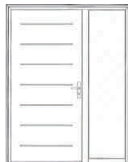
ÉQUATION LARGEUR MAXIMUM AVEC FIXE H 2150 L 1600 FERRAGE UNIQUEMENT SUR DORMANT Au-delà de 1000 mm, possibilité de mettre un fixe en dormant de 400 à 600 mm de large.
